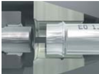
Das Rohrende wird entspannt und kann aus der Maschine entnommen werden
