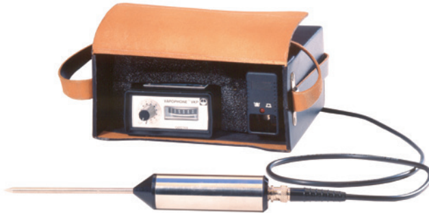
Abb. 66a Ultraschallmessgerät zur Funktionskontrolle der Kondensatableiter – Vapophone VKP 10.
