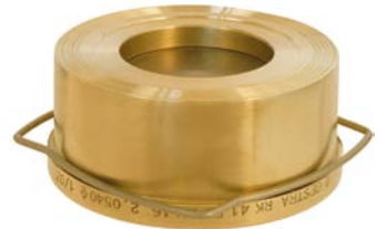
RK 41 mit Spiralzentrierung PN 6 bis PN 16, Gehäusewerkstoff: Sondermessing, Ventilteller: austenitischer Stahl
