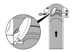
Bei Einbau hinter einem Rohrbogen muss der Augenbolzen zum Inneren des Rohrbogens zeigen.
